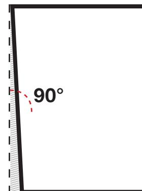
Il sistema telescopico, composto dal profilo laterale a muro e il registro superiore, permette di compensare differenze in larghezza fino a 14 mm mantenendo il cassonetto sempre perpendicolare al pavimento.
